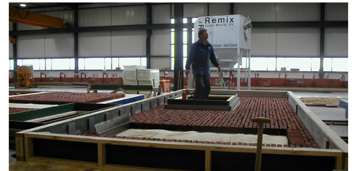
Traditionele productie prefab metselwerk elementen in mallen - © Harrie Vekemans
