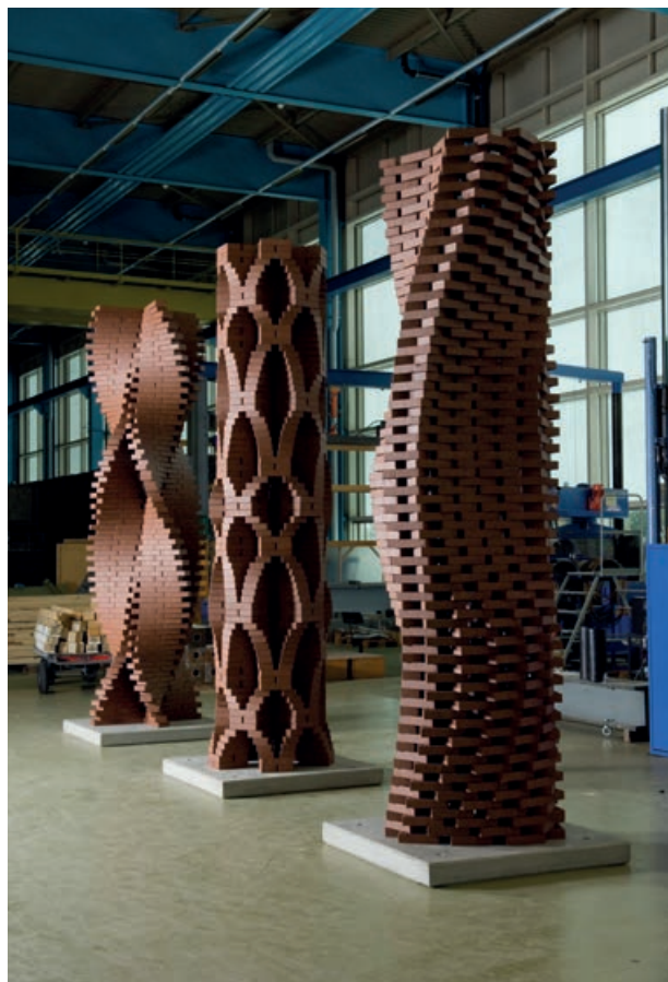
Stapelen van bakstenen zuilen als proef voor de ontwikkelde metselrobot op ETH Zürich. (Foto: Gramazio Kohler Research, ETH Zürich)
