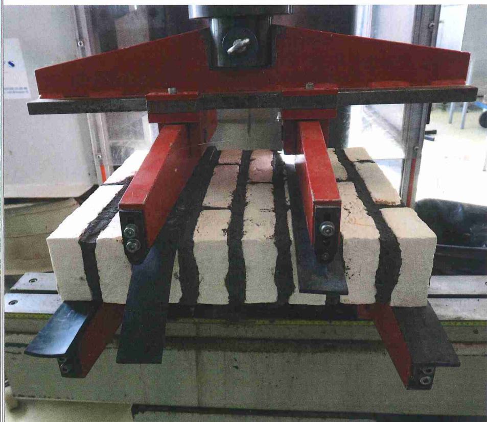
Vierlijnsbuigproef volgens NEN-EN 1052-2 in het laboratorium van TCKI.
