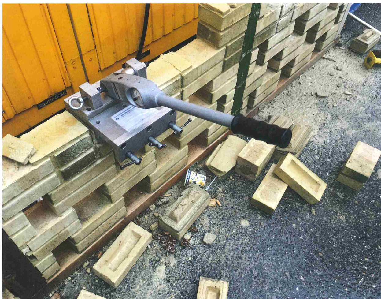
Hefboomproef op Braziliaans metselwerk.
